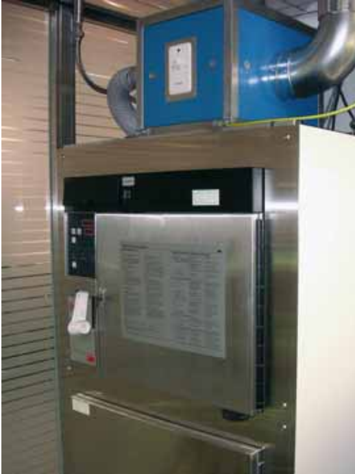
Abbildung 1: Im Unterdruckverfahren arbeitendes Gerät, das mit Ethylenoxid aus Kartuschen versorgt wird.
