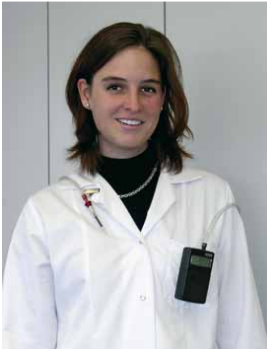
Abbildung 8: Personengetragene Messung mit einem aktiven Probenahmesystem.
