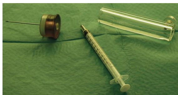
Fig. 2 : Bague en polycarbonate avec canule et protection de seringue. Source: BfS
