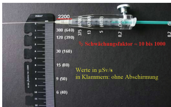
Abb. 1: Dosisleistungsverteilung an Spritzenabschirmung (Messwerte für 185 MBq Y-90). Quelle BFS
