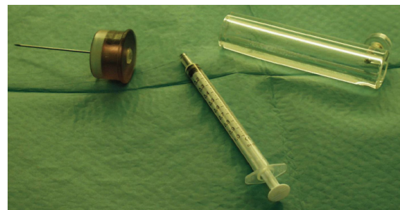
Abb. 2: Makrolonring mit Kanüle und Spritzenabschirmung. Quelle BFS
