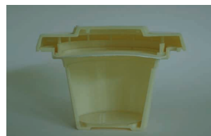
Dosimètre à radon (coupe)
