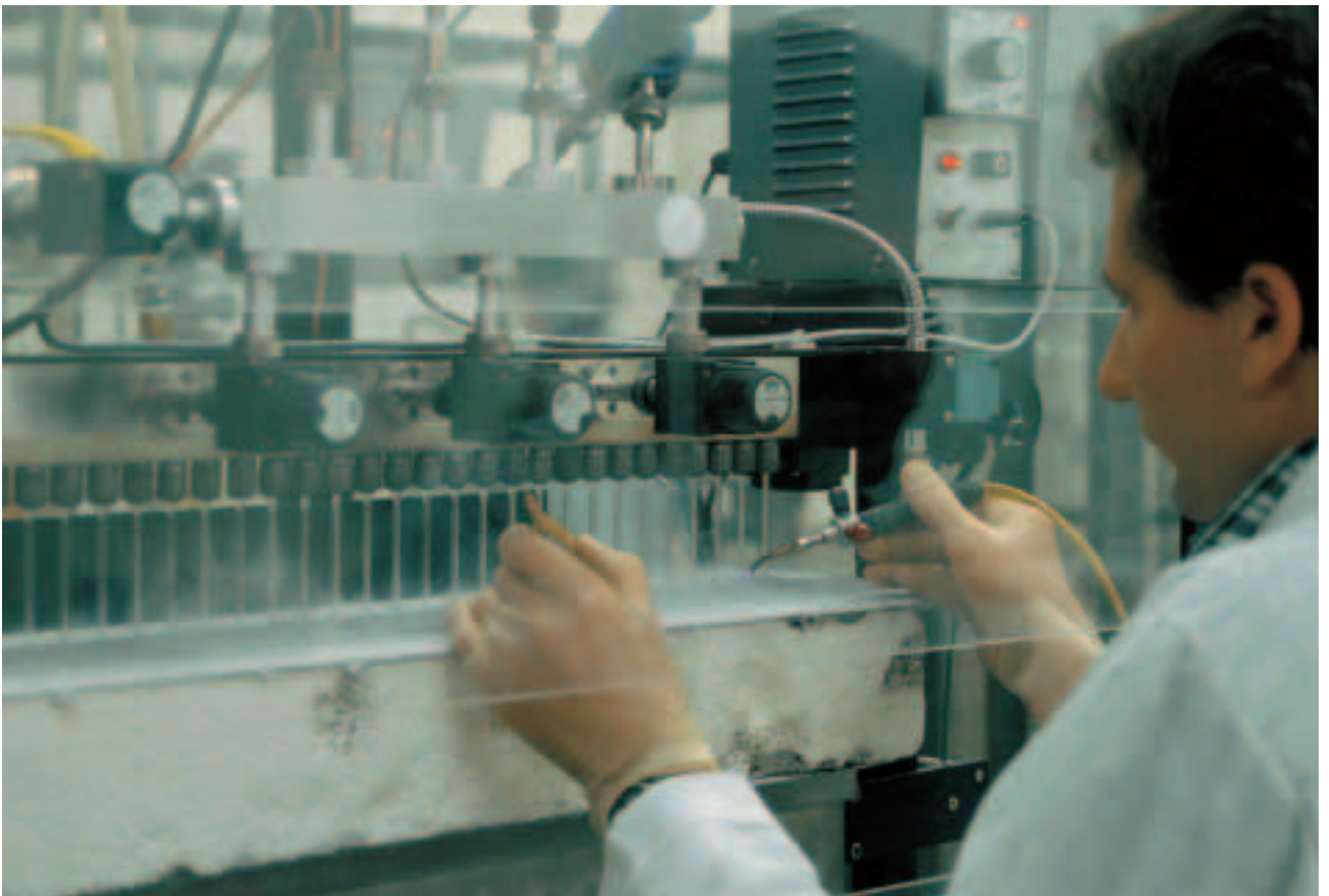
Figures 8 + 9: Fermeture de capillaires remplis de tritium
