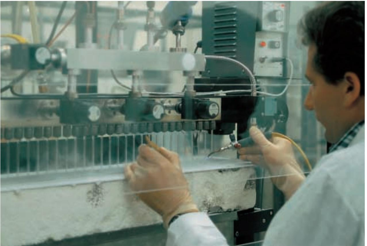
**Abbildung 8 + 9:** Abschmelzen der mit Tritium gefüllten Kapillaren
