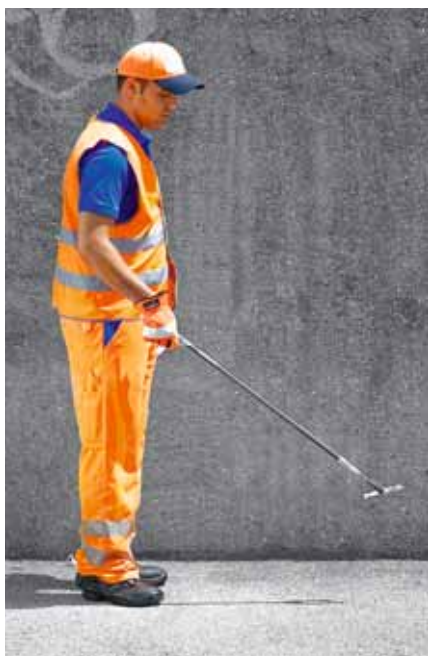
Abbildung 4: Für die Entsorgung spitzer und scharfkantiger Gegenstände sind geeignete Greifinstrumente zu verwenden.
