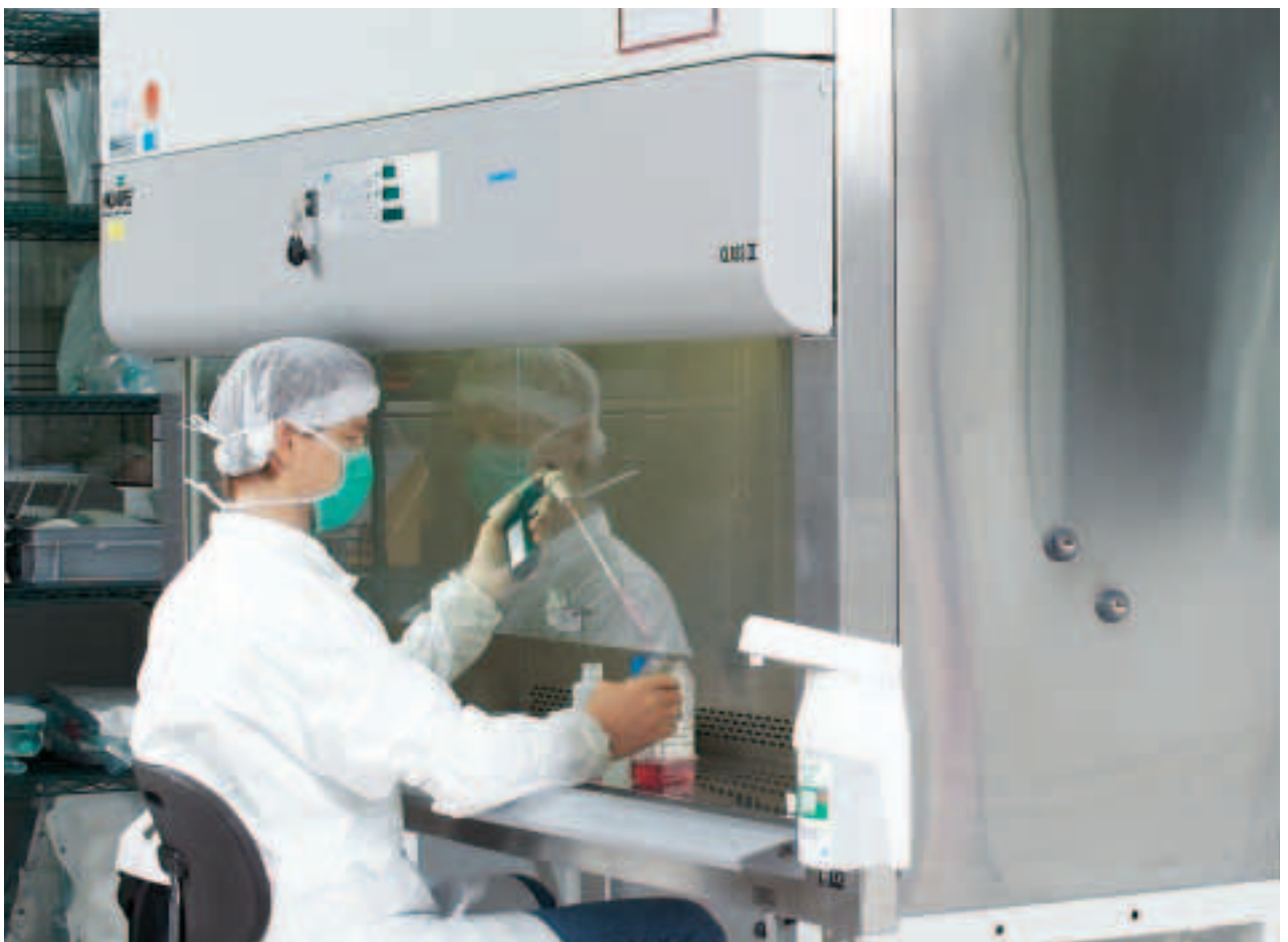
Abbildung 4 Sicherheitswerkbank der Klasse II.
