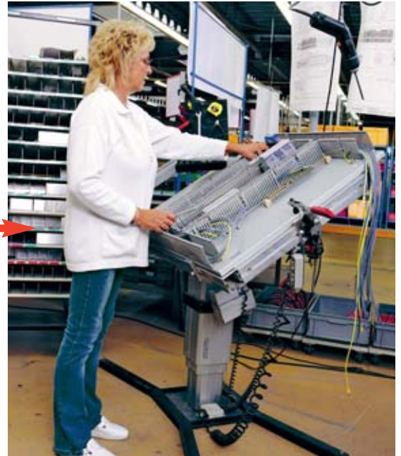
Figure 8 Ce support de montage inclinable et réglable en hauteur permet d'adopter une posture correcte.
