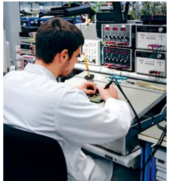
Figure 9 Un support inclinable installé sur la table suffit pour les travaux de précision. Le plateau surélevé à l'arrière offre une meilleure vue d'ensemble.
