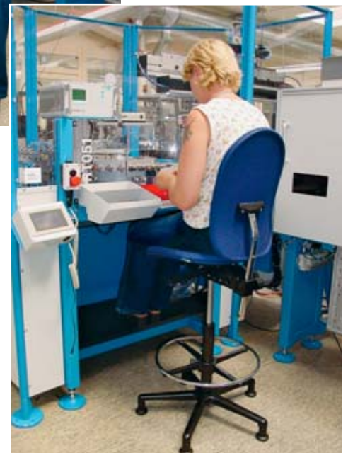
Figure 25 Avec un siège correctement réglé et un repose-pied, l'opératrice travaille à la même hauteur que debout.
