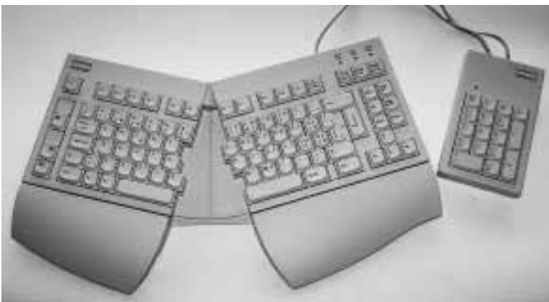
Bild 52 «Ergo-Tastatur» mit einem festen Winkel.
