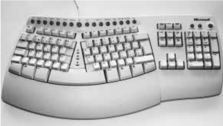
Bild 52 «Ergo-Tastatur» mit einem festen Winkel.
