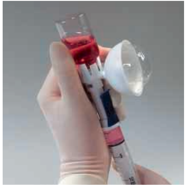
Figure 7 Dispositif fermé pour la fabrication et la reconstitution des cytostatiques PhaSeal®. Le système d'égalisation des pressions empêche la fuite d'aérosols.
